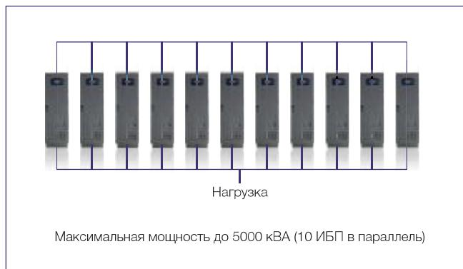
Параллельная конфигурация для увеличения мощности или резервирования
